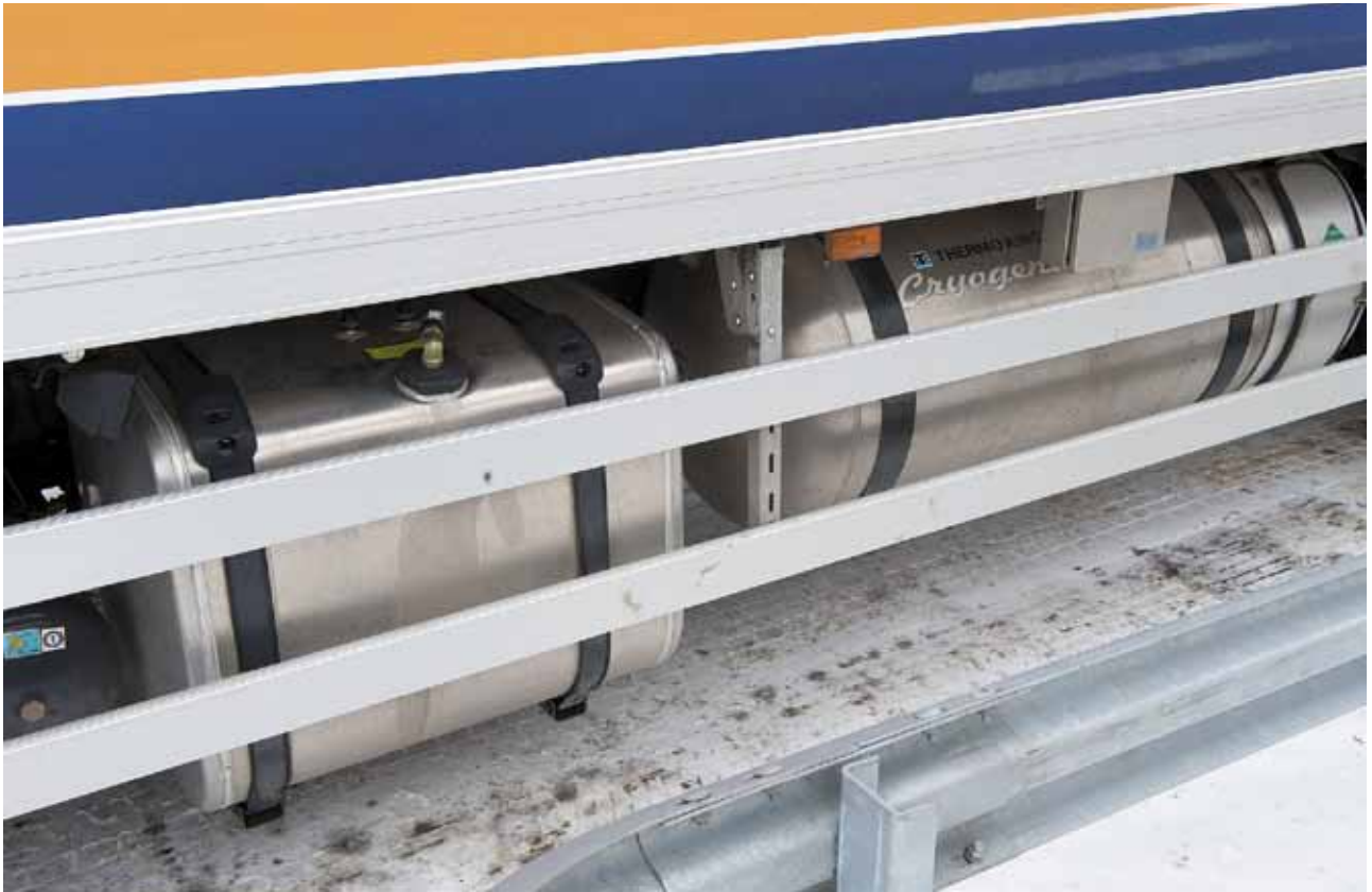
Valion jakeluauton säiliöitä. Vasemman puoleisessa tankissa on bioetanolia ja lieriön muotoisessa nestemäistä hiilidioksidia. Nestemäinen hiilidioksidi on otettu talteen teollisuuden hukkaprosessista. Sillä jäähdytetään kuormakori, jolloin perinteinen dieselkäyttöinen kylmäkone on voitu poistaa.
